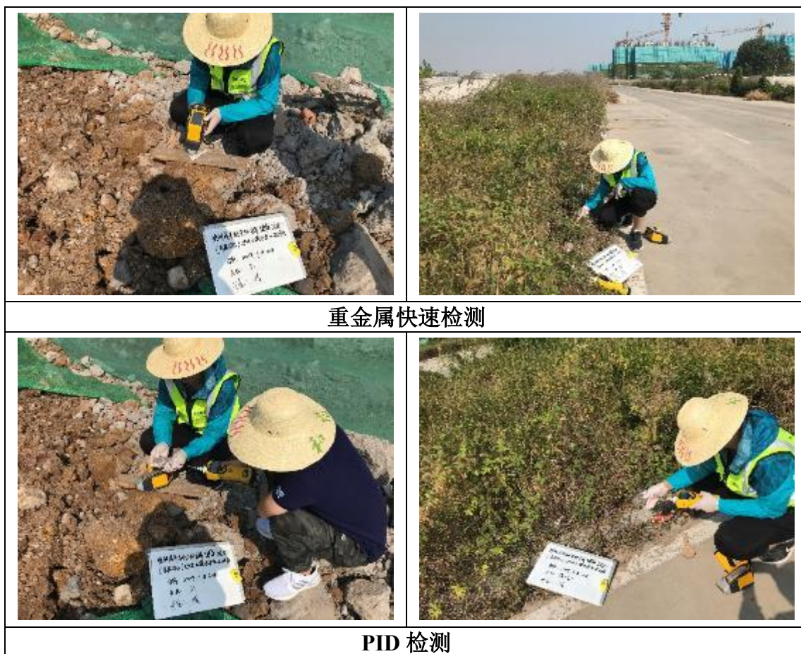
图 3-5 现场快速检测照片
