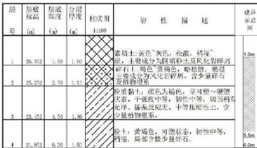
图 6-6 钻孔柱状图及对应的建井示意图
